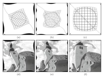
$$T_x^{-1} \colon x = \begin{cases} x_c + r \cdot \cos(\beta) & \text{for } r \le r_{\max}, \\ x' & \text{for } r > r_{\max}, \end{cases}$$
